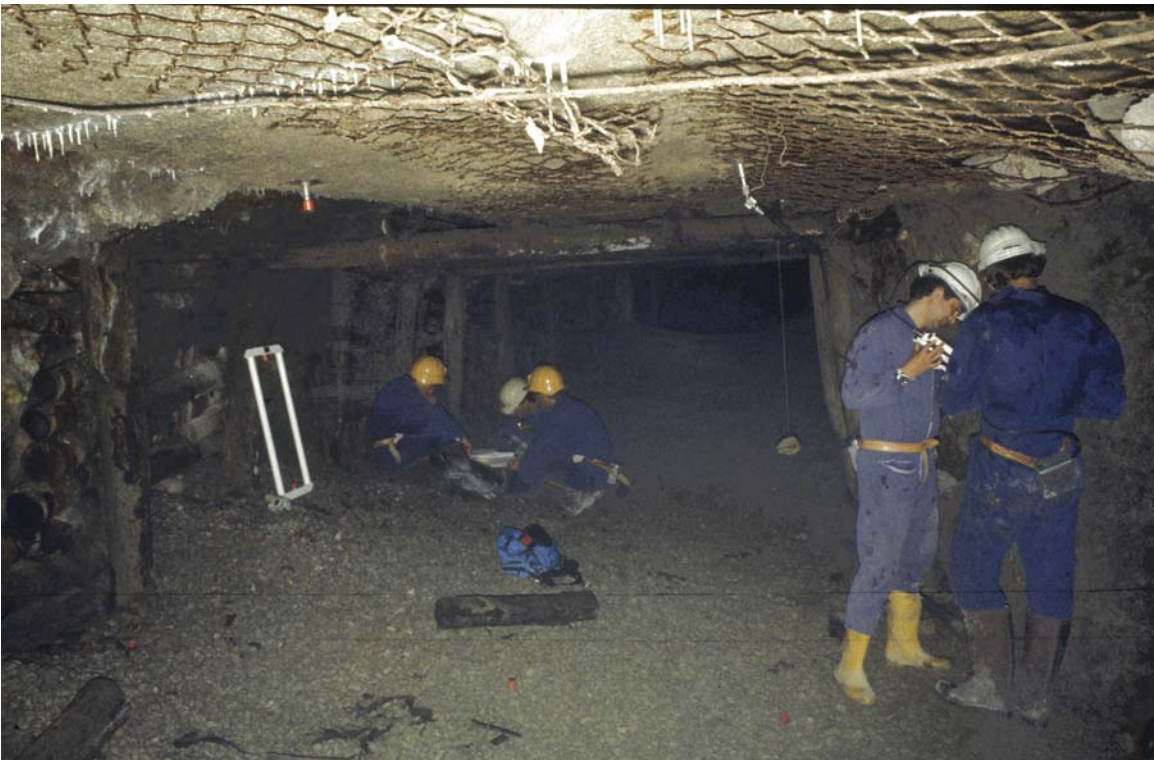
Foto (personale) – Misurazioni sui cedimenti delle pareti nelle aree di coltivazione a solette cementate (a tetto e a letto)
