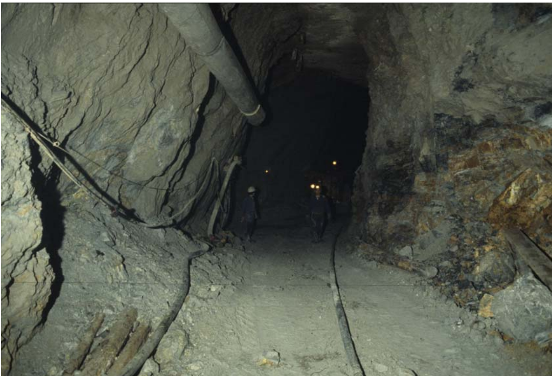
Foto (personale) – 1981 Esempio di galleria di coltivazione in direzione nel settore della coltivazione sperimentale delle “solette cementate” (visibile a tetto) che risparmiavano la necessità della colmata mantenendo il contrasto sulle pareti
