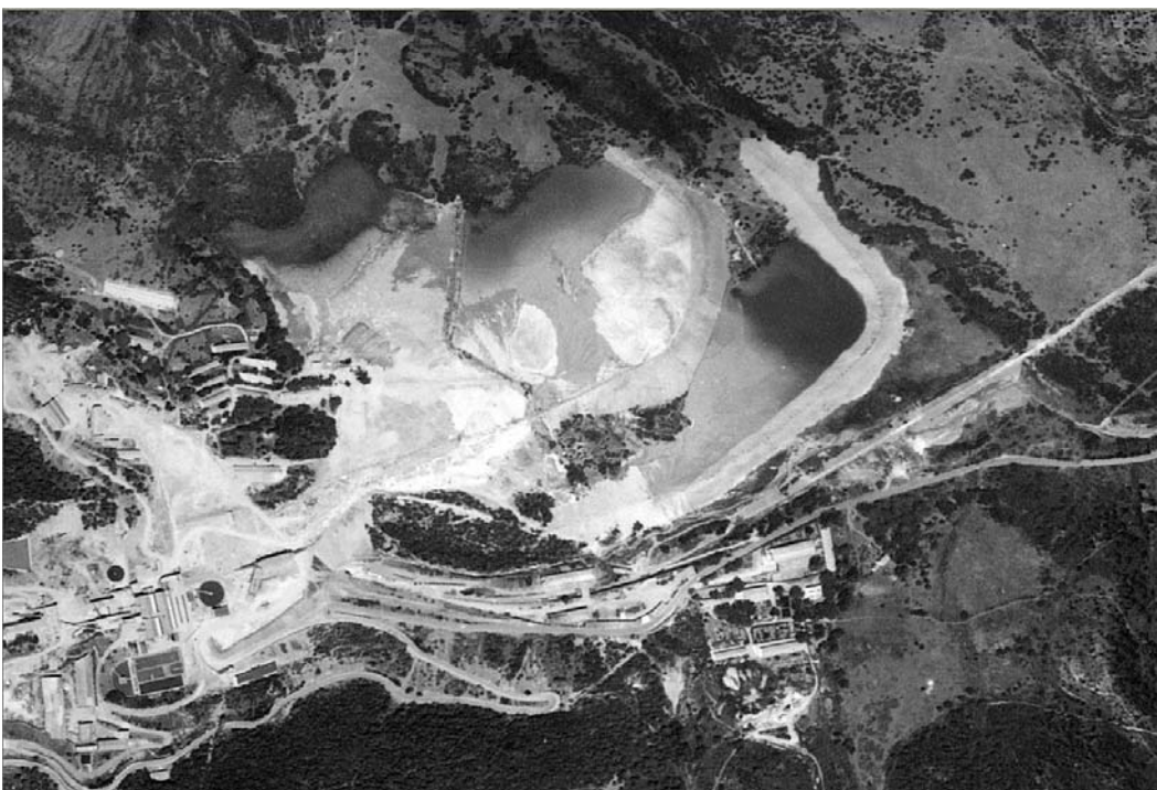
Immagine 1968 con seconda diga portata a quota e capacità sostanzialmente esaurita e primo livello della terza diga in corso di colmata (miniera attiva)
