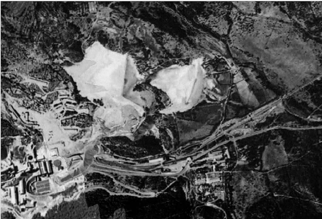
Immagine 1954 con prima diga colmata e seconda diga completata al primo sovrizzo d'argine e limitata presenza di liquido (miniera attiva)
